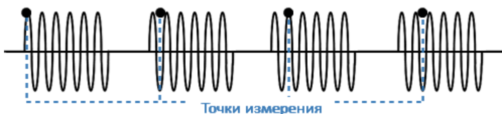
Рисунок 253 – Положение программного строба в режиме «Профиль импульса высокого разрешения»
