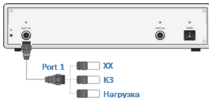
Рисунок 132 – Полная однопортовая калибровка
